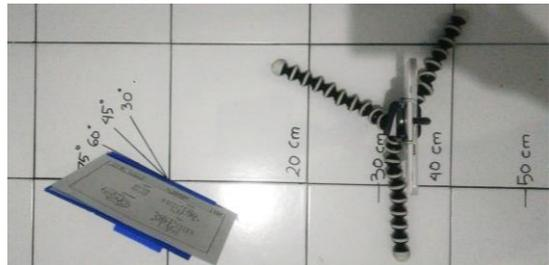
Gambar 29. Cara uji coba deteksi dengan marker dimiringkan 30°, 45°, 60°, dan 75° terhadap kamera
