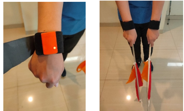
GAMBAR 3. Posisi sensor pada pergelangan tangan.
