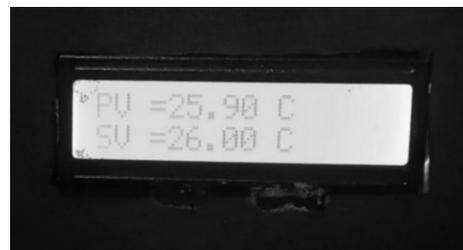
**GAMBAR 27.** Tampilan Suhu Steady State
